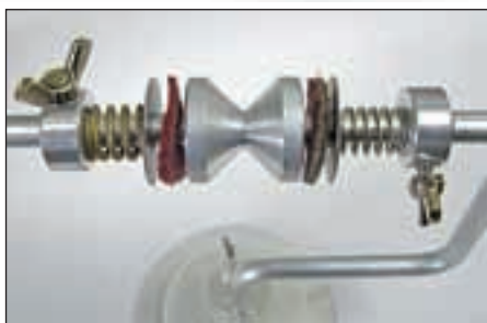
Установив шайбы из фетра и более жесткую пружину, можно увеличить натяжение при намотке.
