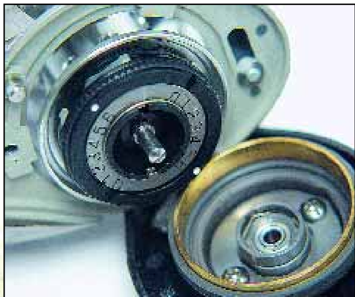
Фото 6. Устройство для регулировки тормозных рычагов катушки MGNOUS (RYOBI).
