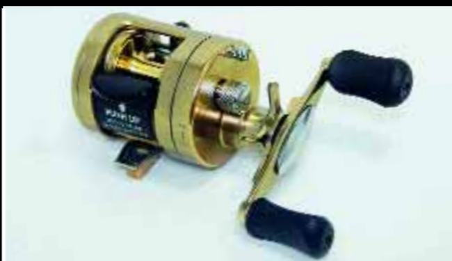
Saiman, Tica, Китай. Масса – 289 г. Цена – 3594 р. Катушка с моноблочным корпусом из алюминиевого сплава, байонетным креплением “редукторной” щеки с фиксацией ее всего одним винтом. Лесокладыватель со вставкой из нитрида титана, отключаемый клавишей для заброса. Редукция – 5,2:1; лесоемкость 130 м мононити 0,30 мм; подтормаживающая система – центробежная с 6 грузиками. Есть тормоз-трещотка, расположенный на боковой несъемной крышке. Передаточная ше-
