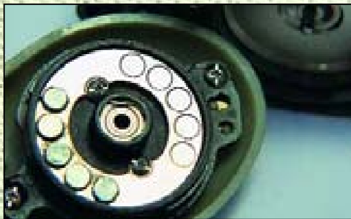
Фото 2. Магнитная система подтормаживания шпули низкопрофильной катушки Bestop.
