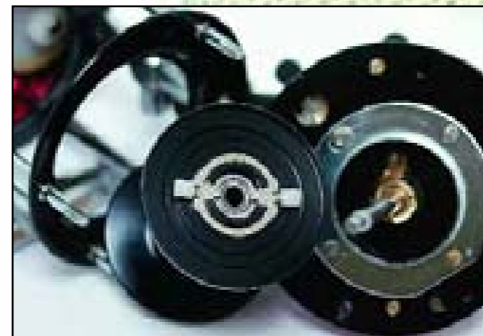
Фото 1. Центробежная система подтормаживания шпули катушки Ambassador 6000 Original.
