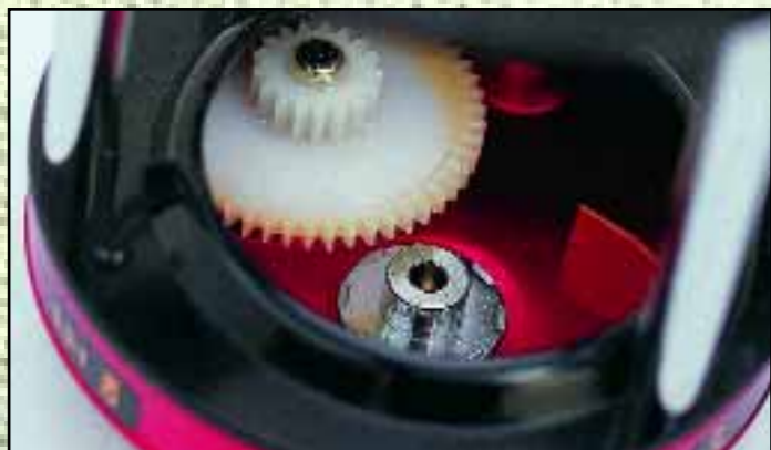
Фото 4. Приводная шестерня механизма лесоукладывателя (модель Ambassadeur 6000 ).
